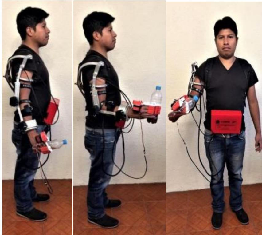
Figura 3. Pruebas de posicionamiento del exoesqueleto acoplado al usuario.
