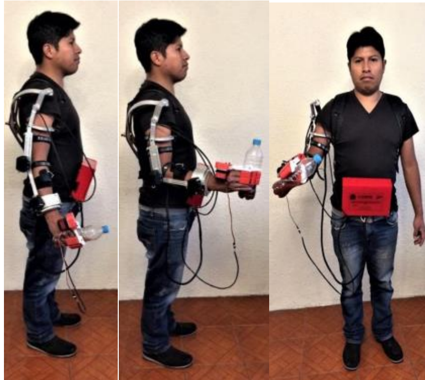
Figura 3. Pruebas de posicionamiento del exoesqueleto acoplado al usuario. Fuente: Elaboración propia de los autores.
