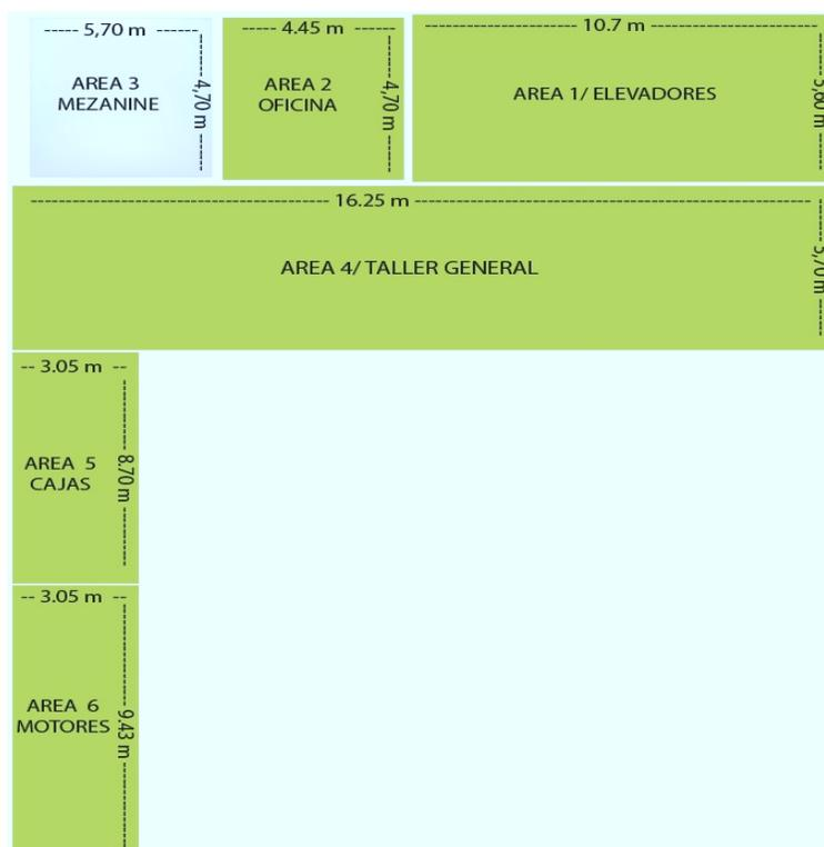
Figura 1. Áreas del taller. Mediciones de largo y ancho de cada una de ellas.
